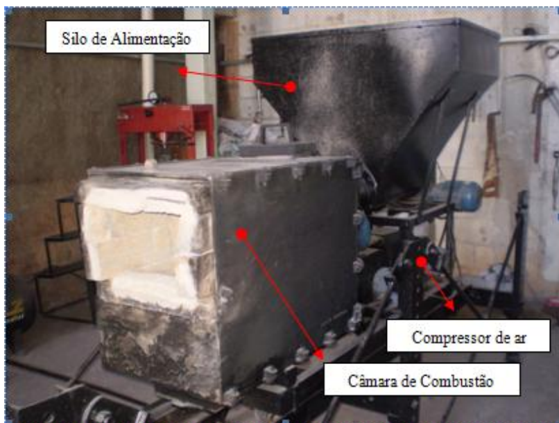
Figura 2: Combustor de biomassa
