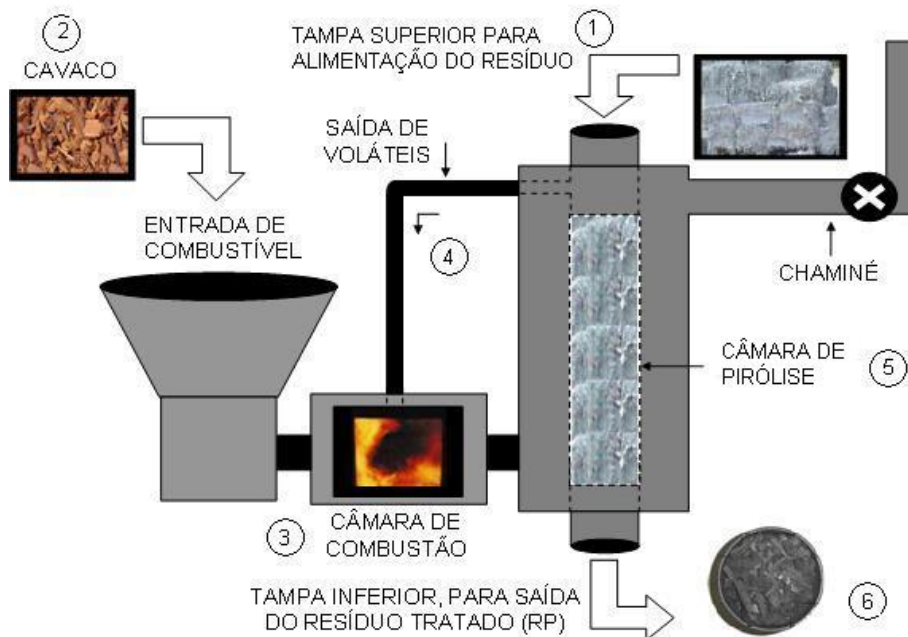
Figura 5: Processo de tratamento de resíduos por pirólise.
