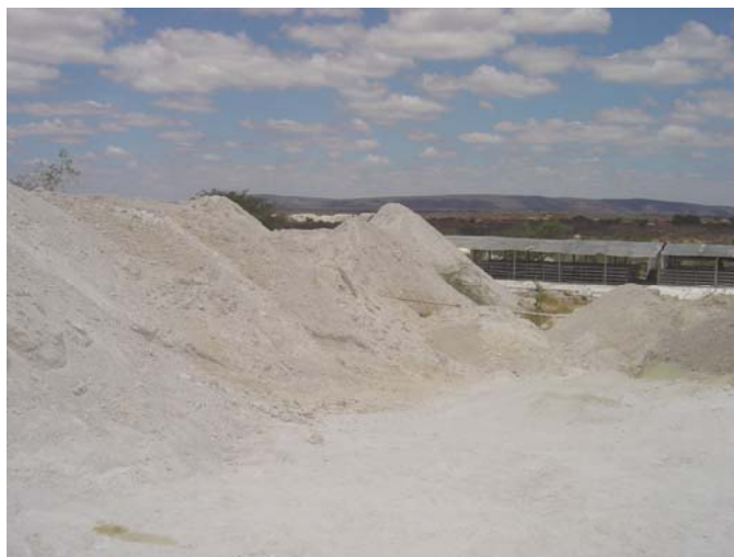
Figura 1: Estocagem do resíduo de caulim a céu aberto
