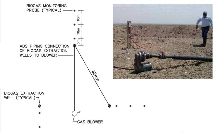
Esquema típico de um teste de bombeamento
